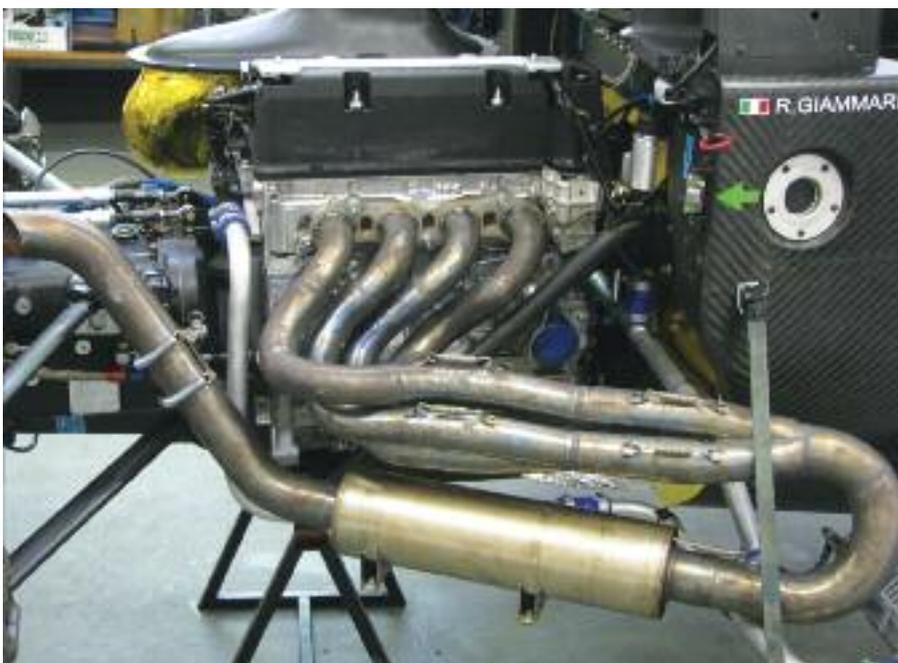
L'impianto di scarico dotato di silenziatore e catalizzatore obbligatori.
