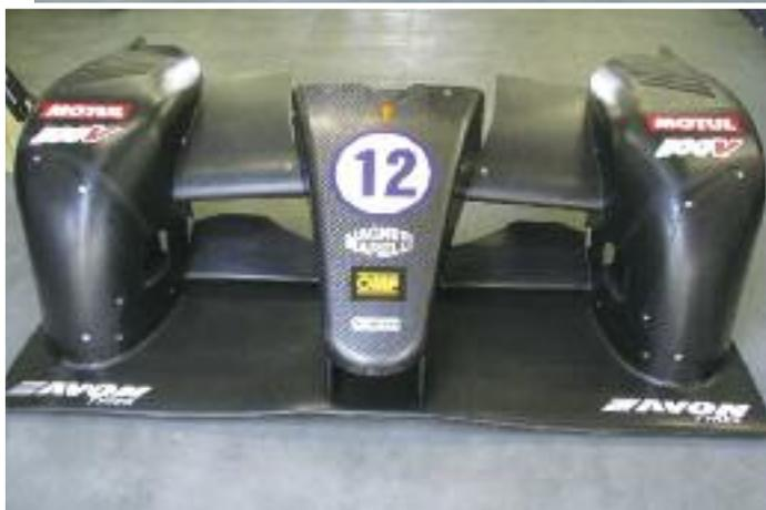
Anche il musetto richiama quello di una monoposto, con gli ampi ingressi ai lati per il flusso d'aria indirizzato verso i radiatori laterali e la parte posteriore, le carenature per le ruote, lo splitter fisso e le ali regolabili.
