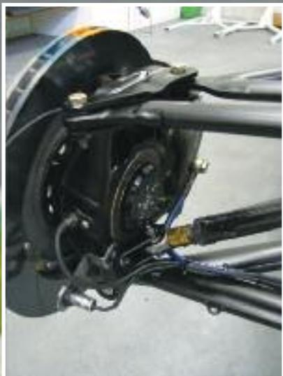
Nella parte inferiore il puntone push-rod è fissato direttamente sul montante. Nella parte alta dello stesso si notano gli spessori, a piastrelle, che servono per variare l'angolo di camber. Nella parte centrale del montante è inserito il sensore velocità di rotazione, mentre più in basso, supportato da una staffettina, quello per la rilevazione della temperatura dei dischi freno.
