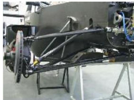
Oltre allo schema della sospensione anteriore push-rod, a triangoli sovrapposti e puntone di reazione, si nota la chiglia della scocca con il generoso scalino per agevolare il passaggio dei flussi d'aria nella parte inferiore.
