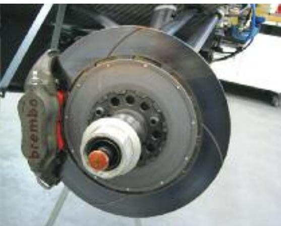
Il disco freno anteriore autoventilato da 278 mm, accoppiato alla pinza Brembo a quattro pistoncini.
