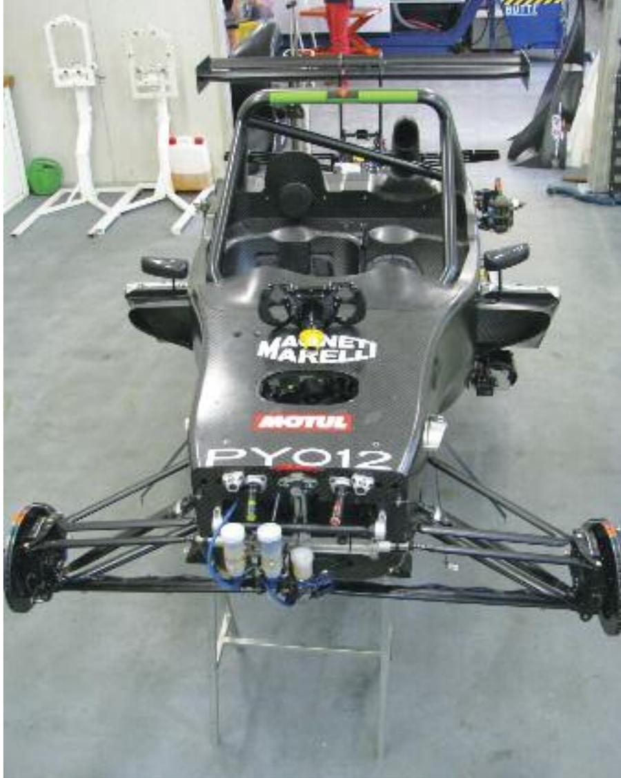
La costruzione in composito ha consentito di adottare per la scocca linee morbide e rotonde, a tutto vantaggio dell'aerodinamica e dei valori di resistenza.
