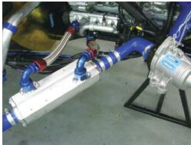
Si nota la pulizia di applicazione del quattro cilindri Honda 2.0 in versione Gr. N e della relativa accessoristica: nella parte bassa del motore si nota la pompa olio spostata a sinistra, in primo piano la pompa acqua elettrica e lo scambiatore di calore acqua-olio. Tutto il blocco, compreso il radiatore acqua e il retrotreno, può essere smontato dalla scocca senza staccare nessun raccordo.
