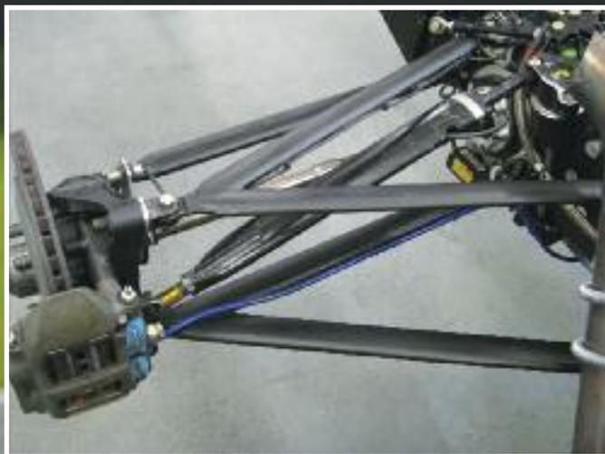
Vista della sospensione posteriore, sempre a schema push-rod; sulla scatola del cambio, al centro del cocker, si nota la barra di torsione posizionata verticalmente.
