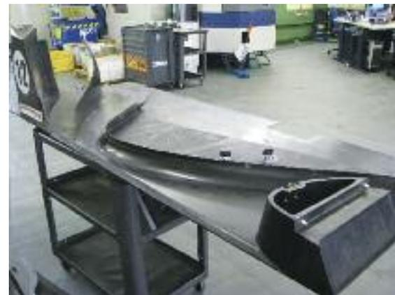
La parte destra del fondo ci consente di apprezzare la sinuosità della parte bassa delle fiancate ed i deflettori per incanalare il flusso d'aria verso l'estrattore posteriore.
