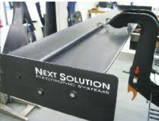
L'alettone posteriore biplano con il caratteristico attacco superiore "a cigno" per non "sporcare" il flusso d'aria inferiore.
